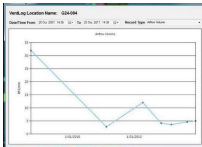
Figura 0-12 Un ejemplo que muestra datos de Ventlog en el formato de un gráfico
