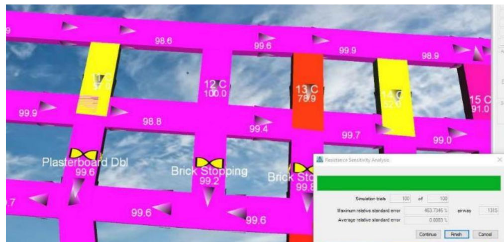
Figura 29-5 Los resultados después de haber realizado un análisis de sensibilidad a la resistencia los cuales demuestran la cantidad de confianza (%). Una confianza baja en el caudal suele encontrarse en galerías transversales.
